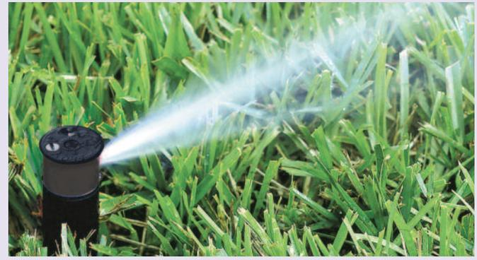
Der MiniPro ist ein Getrieberegner mit einer Wurfweite von 5,2 bis 9,1 m bei einem Düsendruck von 2,1 bis 3,4 bar und mit einer Sprührate von 2,84 bis 12,5 Litern pro Minute abdecken kann. Der MiniPro verfügt über fünf (5) zahlencodierte, austauschbare Düsen. Der Strahlanstieg der Regnerdüse ist 26°. Der Regner hat eine Radiuseinstellschraube aus Edelstahl.
